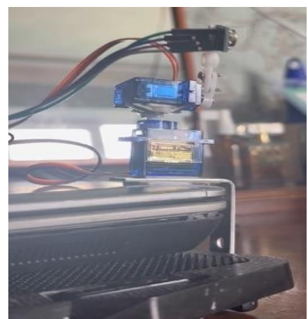
Рис. 2. Апаратна складова системи: отримання теплової карти
