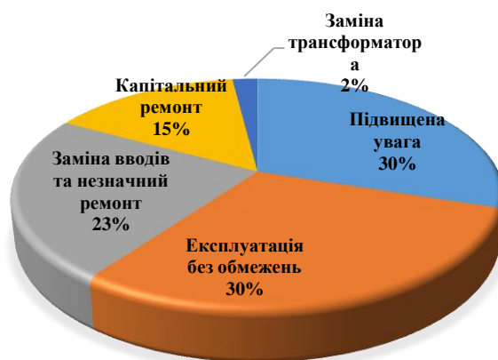
Рис. 1. Результати обстежень 200 силових трансформаторів
