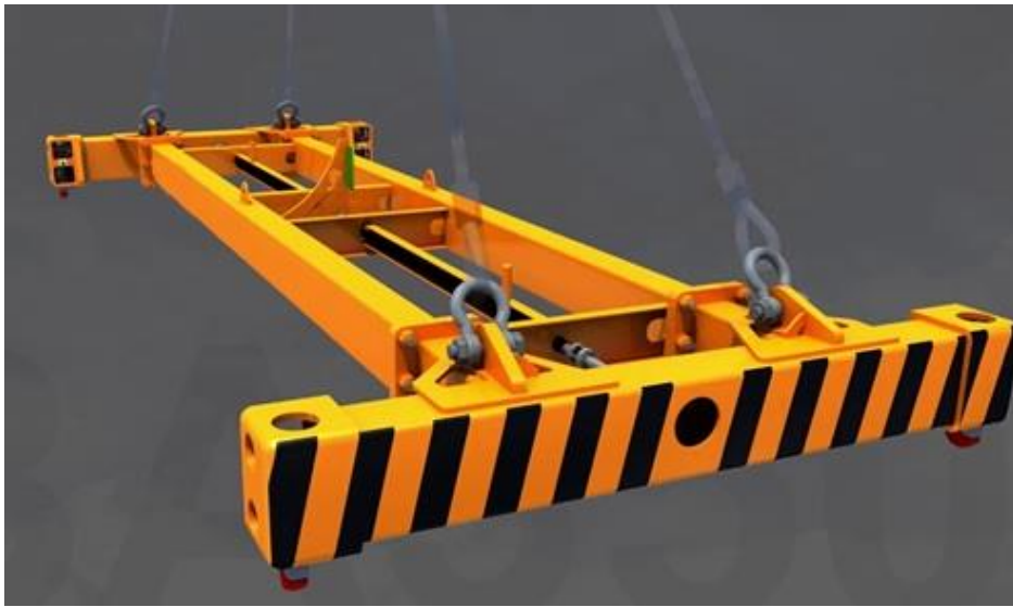
Рис. 1. Загальний вид спеціальних захватів для контейнерів.
