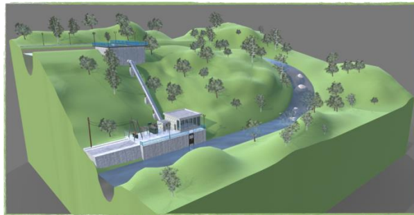
Рис. 1. 3D-модель застосування технології «Run-of-the-river» на малій гідроелектростанції
