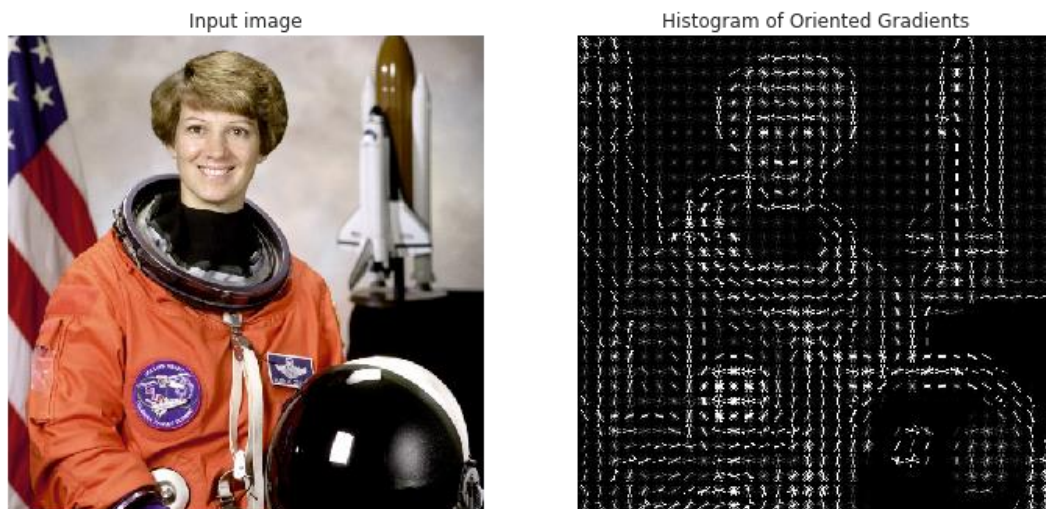
Рисунок 2. Метод Histogram of Oriented Gradients
