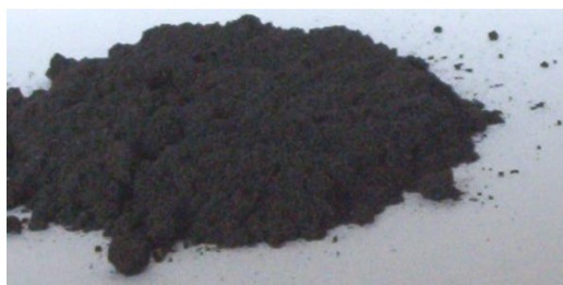
Рис. 1. Шлам сталі ШХ15
