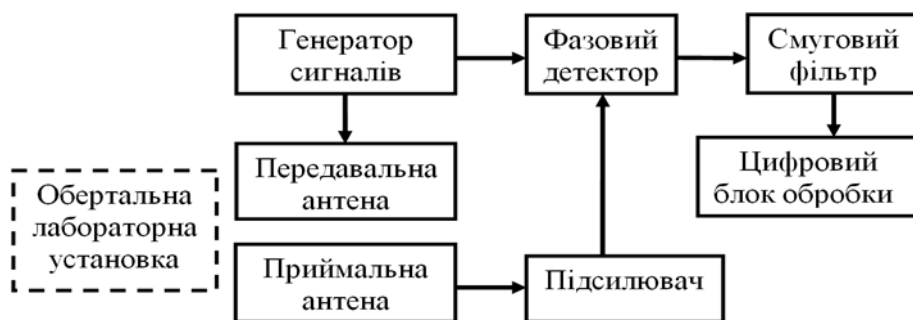
Рис. 1. Структурна схема макету РС
