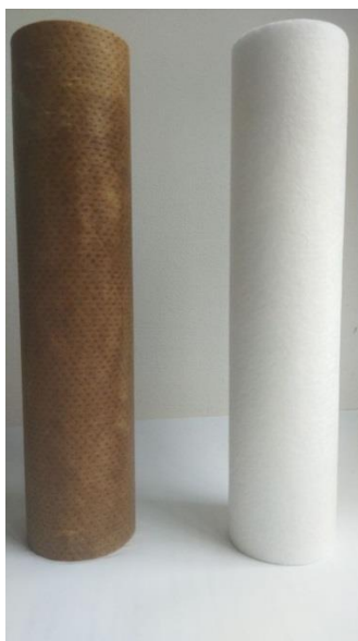
Рисунок 3 – Зовнішній вигляд типового 10 " поліпропіленового картриджа: чистого та забрудненого
