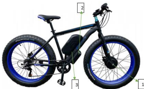
Рис. 1. Компонування електровелосипеда (1 - електричний двигун, 2 – контролер, 3 - акумуляторна батарея)
