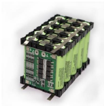
Рис. 4. Невелика літієво-іонна батарея з платою BMS
