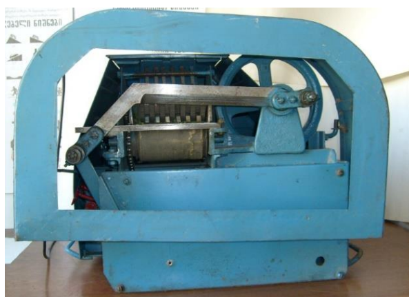
Рис. 1. Установка для резки листьев шелковицы «РТЛ-25» .
