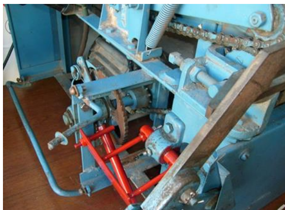
Рис. 6. Конструкция модифицированного механизма изменения ширины полосы при резке листьев.
