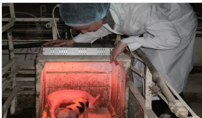
Рис. 1. Опромінювач ІЧУФ-1 з дозою 500 Вт інфрачервоного світла з доповненням ультрафіолетового опромінення потужністю 15 Вт
