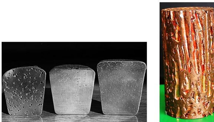
Рис. 1. Пористі виливки різних металів та злиток газара
