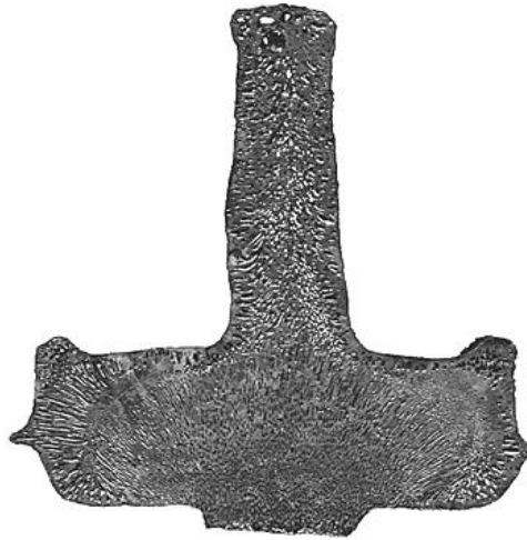
Рис. 5. Вієрообразна структура вилівка хрестоподібної форми зі стабільною структурою.
