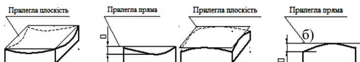
Рис. 9. Увігнутість/ Опуклість -відхилення від а) площинності б) прямолінійності
